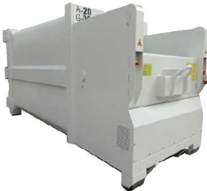
Diseñamos y construimos tanto estructura como la automatización e integración de componentes oleohidráulicos y el montaje de los sistemas de autocompactación. Unidad de compactación multifuncionales, como unidad estacionaria, parte de otra unidad o para transporte el contenedor. Cuenta con una fuente de poder que en base a un motor eléctrico acoplado a una bomba hidráulica comandado por un panel de control, la cual genera el flujo hidráulico necesario para la compactación.
